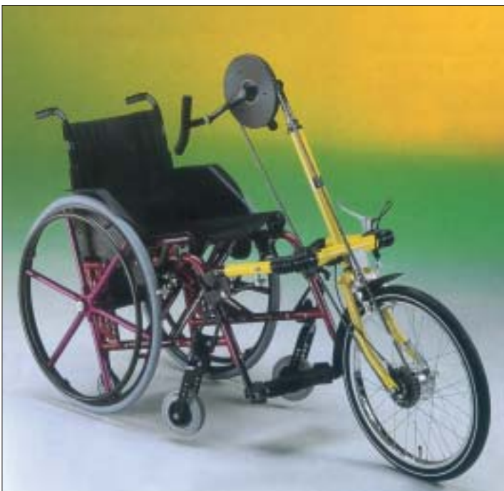
Foto n. 81 - Ausilio dotato di ruota ausiliaria per la propulsione a manovella; la ruota, montata su un telaio, è agganciabile ad una normale carrozzina manuale, trasformandola in un ciclo dotato di cambio a 7 o 21 rapporti. Permette di raggiungere velocità considerevoli ed è adatta a percorsi asfaltati.
