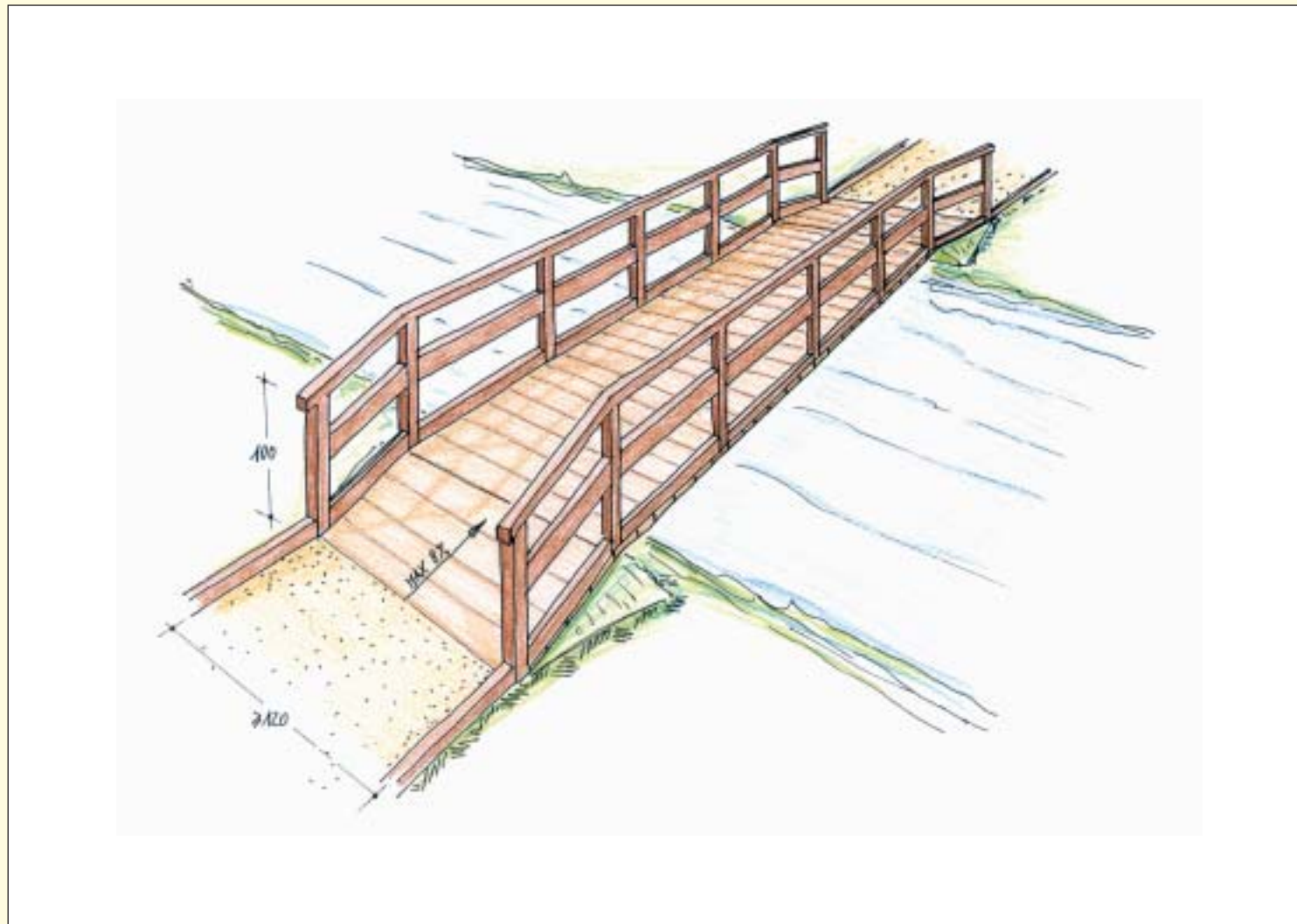
Tavola 36: Schema progettuale per un piccolo ponte
