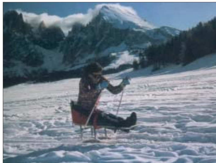
Foto n. 76 - Slittino speciale per sci alpinismo, con struttura metallica alla quale sono agganciati due sci da fondo.
