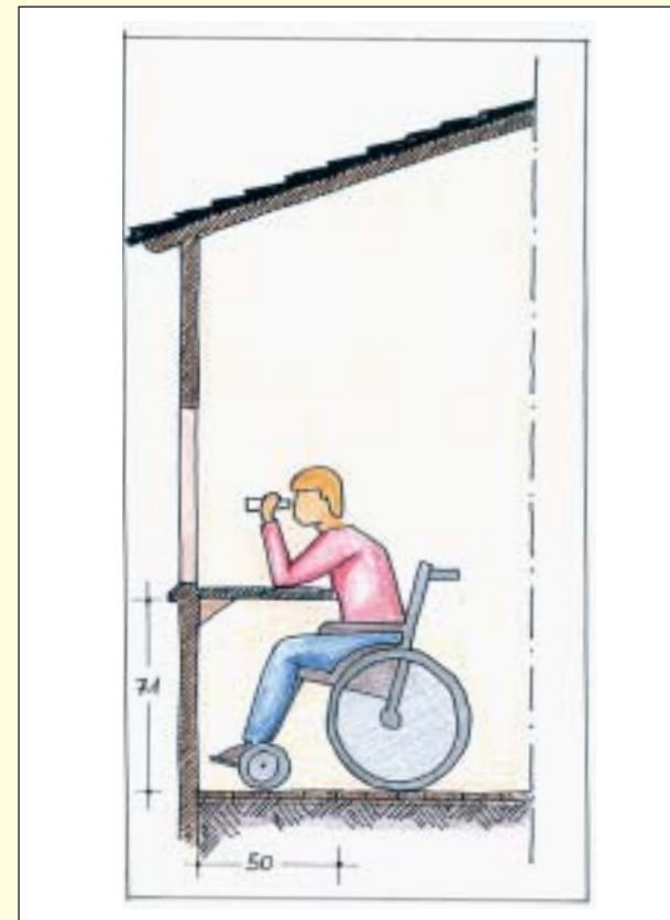
Tavola 11: Capanno d'avvistamento con una semplice mensola d'appoggio.
