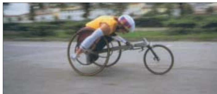
Foto n. 69 - Carrozzina manuale da corsa, per lunghe distanze; adatta esclusivamente a fondi asfaltati.
