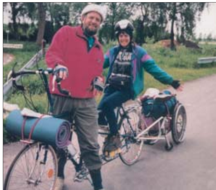
Foto n. 82 - Tandem al quale è agganciata una carrozzina manuale; utile anche al trasporto bagagli.
